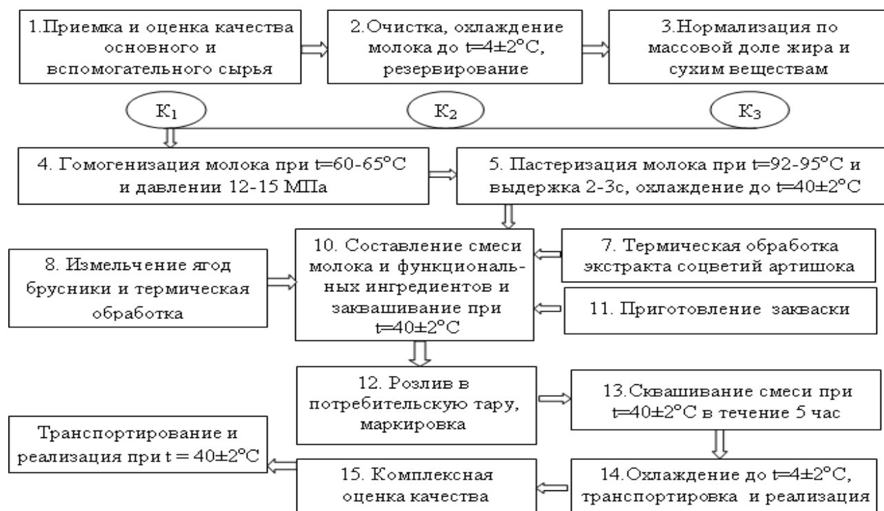
Рисунок 1– Технологическая схема производства функционального кисломолочного продукта термостатным способом:
