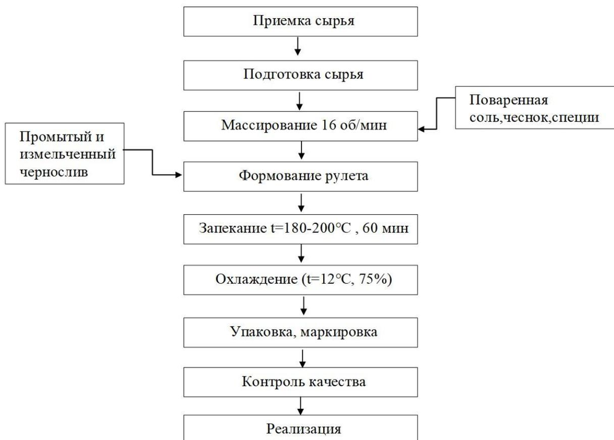
Рисунок 1 – Технологическая схема производства запеченного рулета
