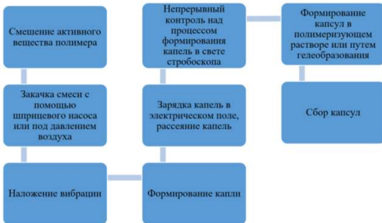
Рисунок 2 – Технологические этапы инкапсулирования методом вибрации
