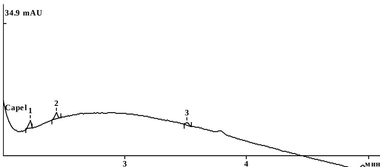
Рисунок 1 – Электрофореграмма определения хлорида и сульфата в водном растворе экстракта дуба, пик № 1 – хлорид – 357 мг/кг, пик № 2 – сульфат – 332 мг/кг
