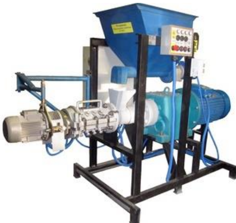
Рисунок 4 - Экструдер ЭТР-500/30-КО производству ООО Агростимул, (г. Киров, Россия).
