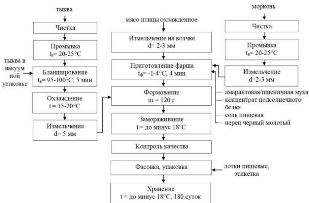
Рисунок 1 – Технологическая схема производства опытных рубленых замороженных полуфабрикатов
