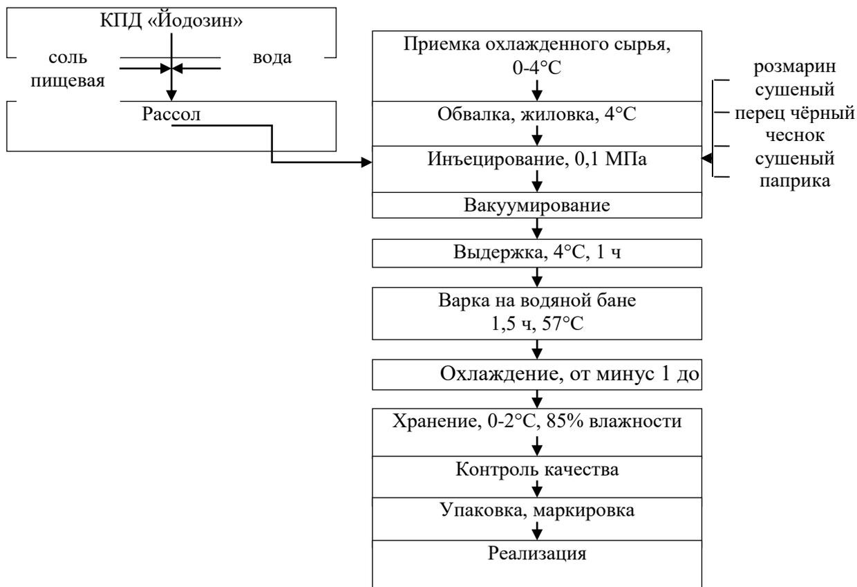
Рисунок 1 – Технологическая схема производства полуфабрикатов из мяса индейки
