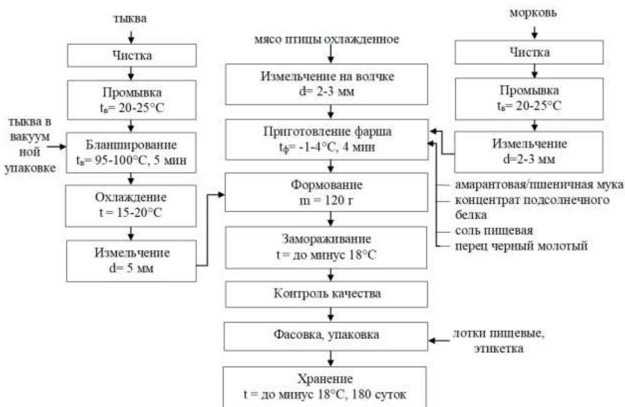
Рисунок 1 – Технологическая схема производства опытных рубленых замороженных полуфабрикатов
