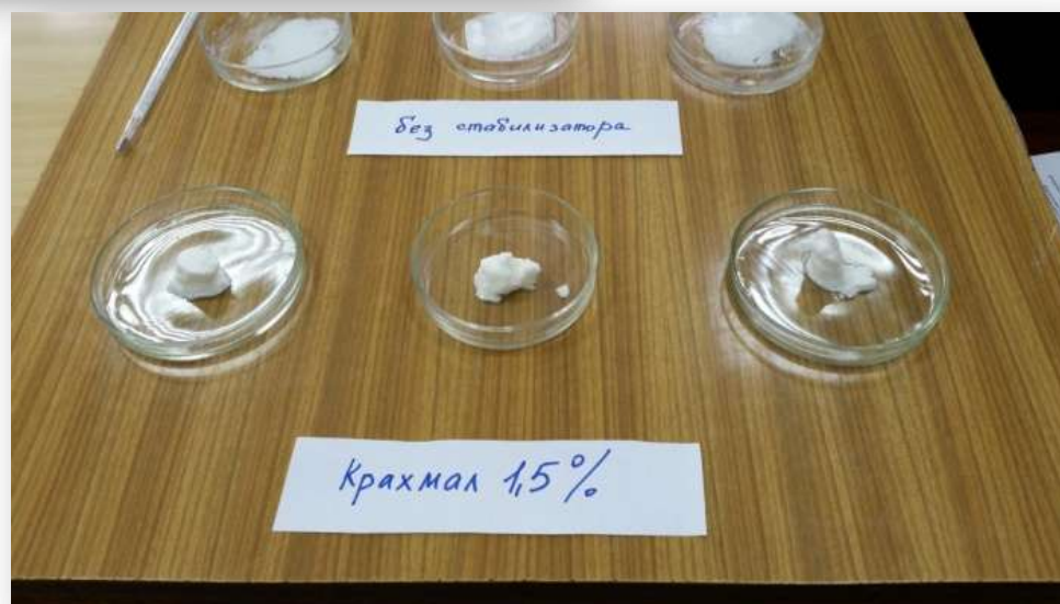
Рисунок 1 – Проведение исследования на определение времени таяния образцов
