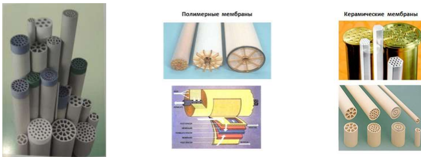
Рисунок 6. Виды многоканальных трубчатых мембран Figure 6. Types of multichannel tubular membranes
