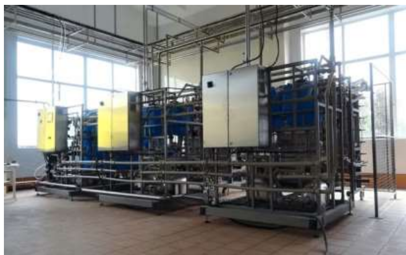
Рисунок 7. Опытно-промышленная электродиализная установка для обработки лактозосодержащего сырья
