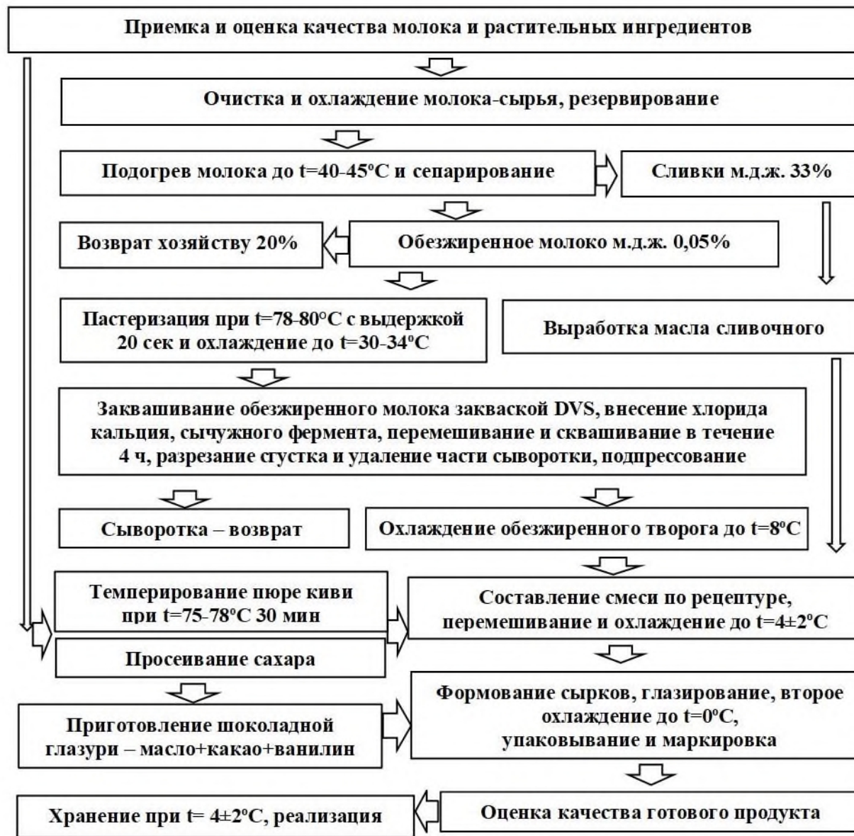
Рисунок 1. Технологическая схема производства глазированных сырков Figure 1. Technological scheme of production of glazed curds
